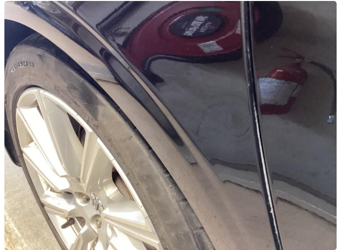
1.1 Skade hjulbue høyre bak. små bulker (skal utbedres)
