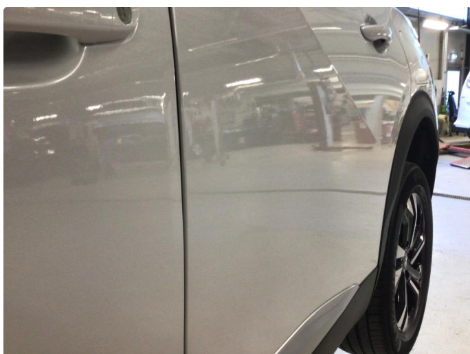
1.2 Bulk opp på fals døråpning førerdør
