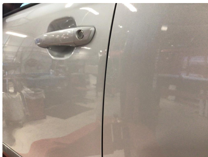
1.2 Bulk opp på fals døråpning førerdør
