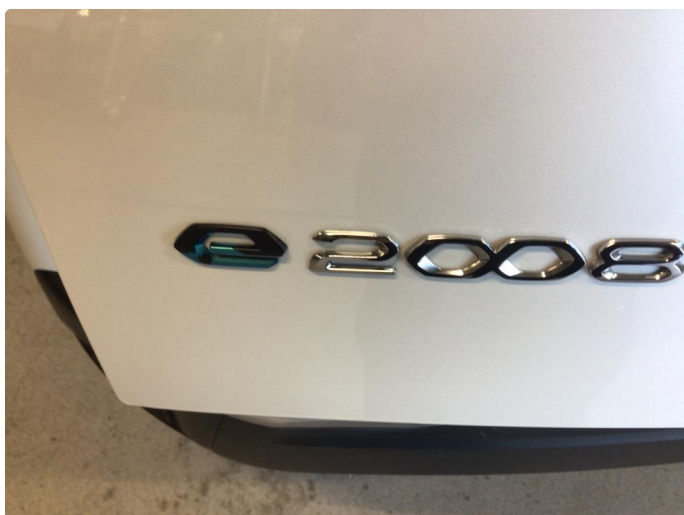
1.1 Grønn farge har flasset av E logo vs og hs foran og bak.
