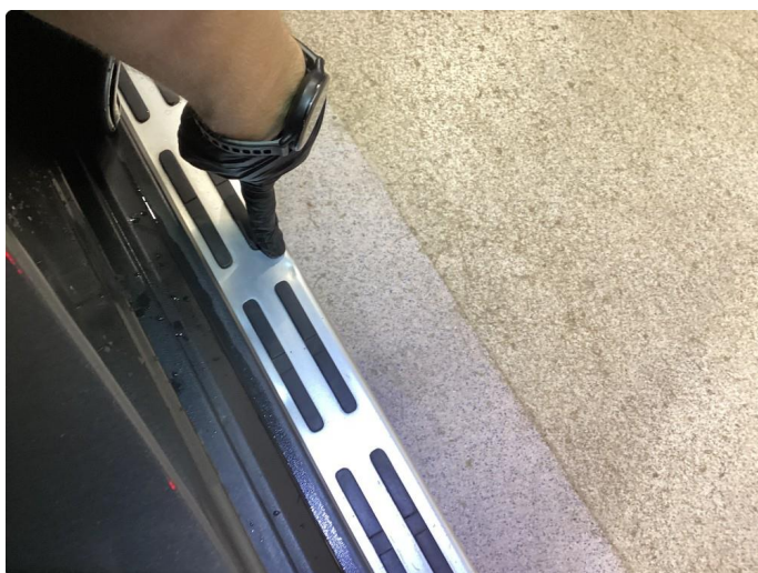
1.4 Stigtrinn/kanalskjørt begge sider små bulker etter steg.
