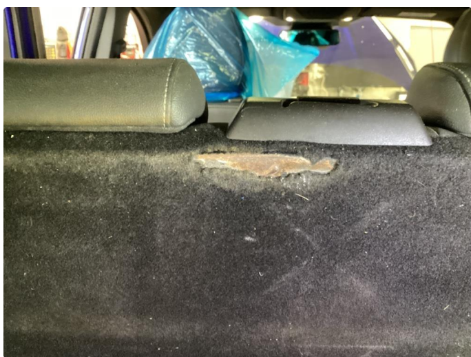
4.1 Skade på seterygg baksete
