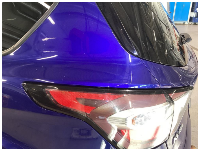
1.1 Noe bruksslitasje i lakk og riper rundt om. Skrubbskade på skjerm og skjermelist bsb, skade på kanalskjørt hs, riper i bakluke Rustfleck på tak
