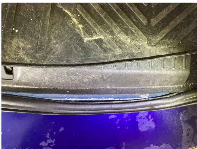
1.4 Pakning skadet bakluke
