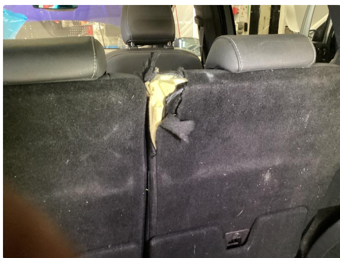
4.1 Skade på seterygg baksete
