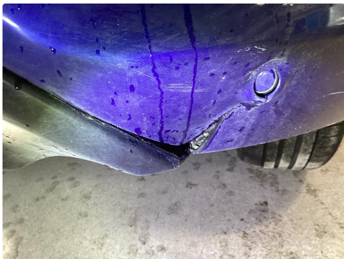
1.6 Skade på støtfanger bsk., dette fører til at krok ikke går helt inn som den skal. Krokkontakt stopper i støtfanger.
