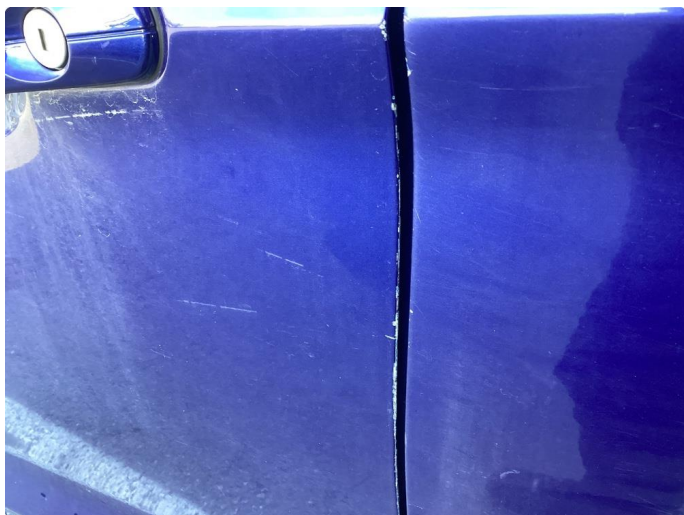
1.3 En del lakkflass/hakk i kant på dører rundt om.
