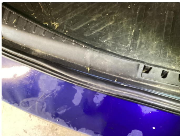
1.4 Pakning skadet bakluke
