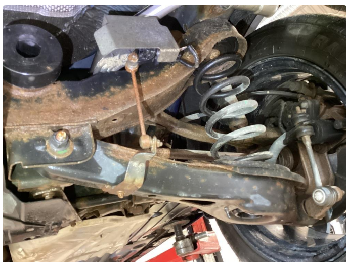
1.2 Noe overflaterust i travers bak. Ingenting alvorlig.
