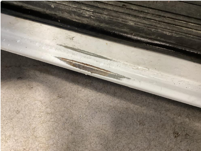
1.1 Lakkslitasje i innsteg på førersiden
