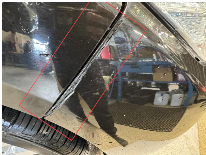
1.8 Noen riper på frontfanger høyre side.
