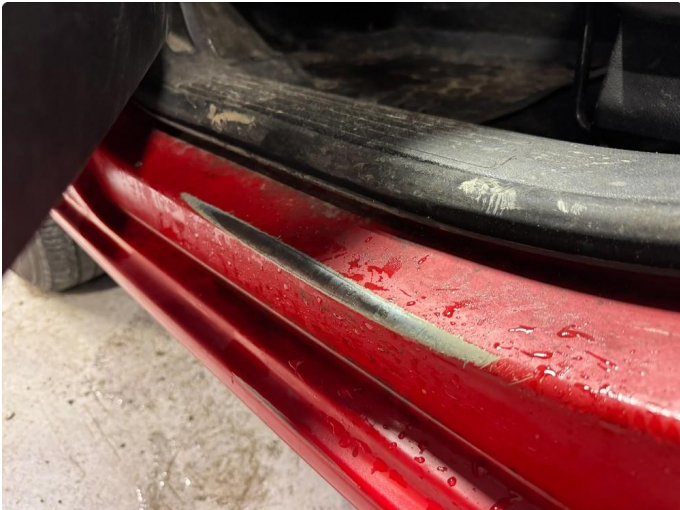
1.4 Slitt gjennom lakk innsteg førerdør
