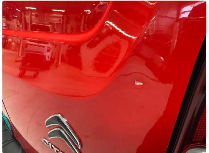
1.3 Noen bulker på høyre bakdør
