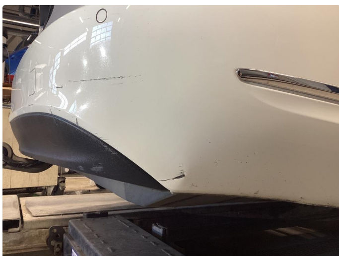
1.2 Liten skade på støtfanger bak høyre side.
