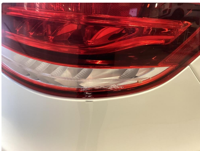
1.2 Liten skade på støtfanger bak høyre side.
