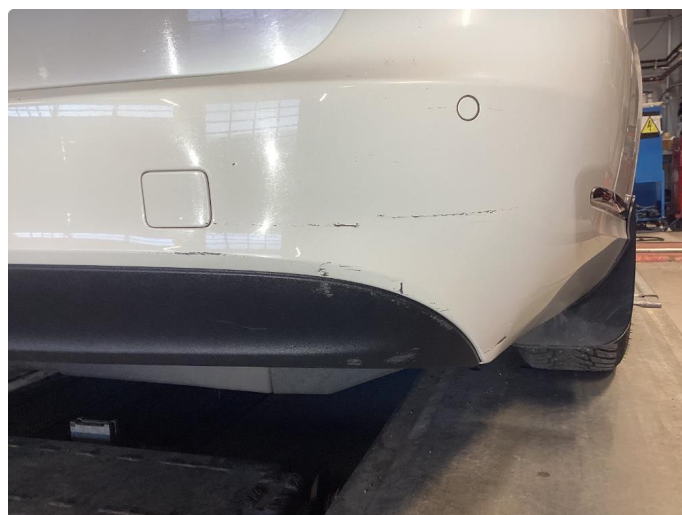
1.2 Liten skade på støtfanger bak høyre side.
