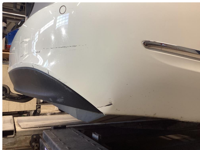
1.2 Liten skade på støtfanger bak høyre side.
