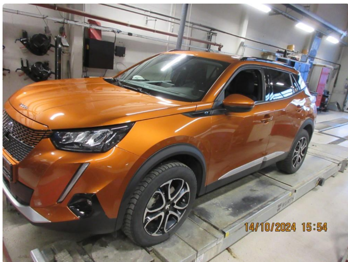
1.1 Bilen ser generelt sett ganske bra ut, men der finnes litt steinsprangmerker på frontfanger, panser og frontrute (ingen sprekker i rute)
