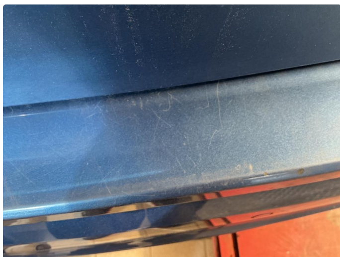
2.4 Ripe(r) ned til grunning
