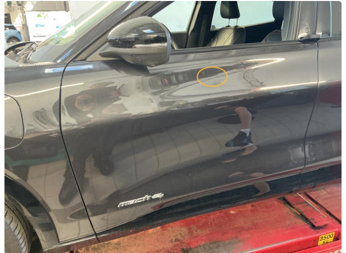
1.1 Ripe ned til grunning
