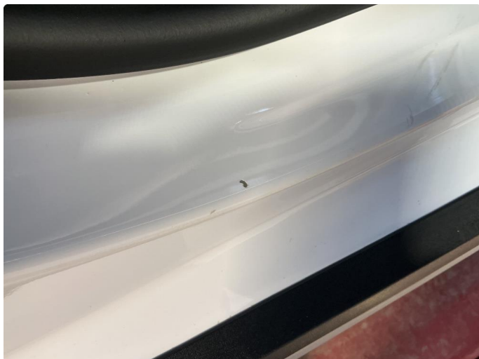
1.2 Bulk med lakkskade
