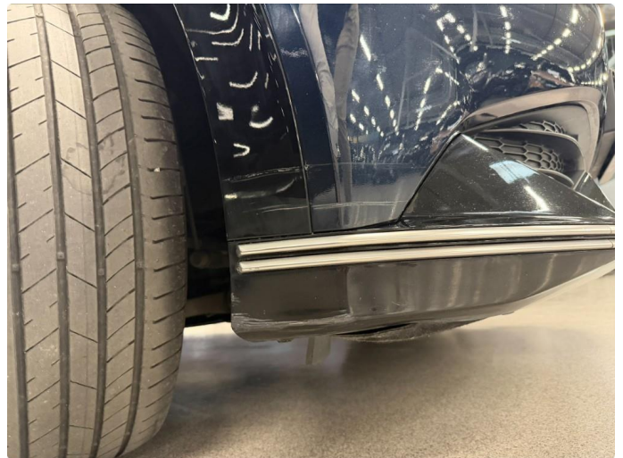
1.2 Ripe(r) ned til grunning
