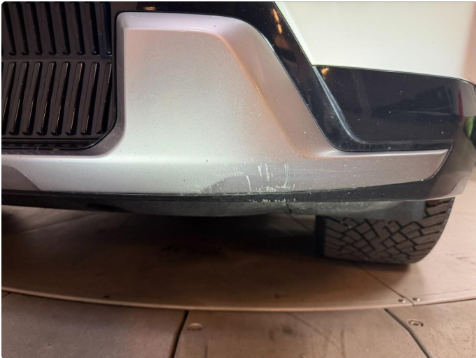
1.1 Ripe(r) ned til grunning
