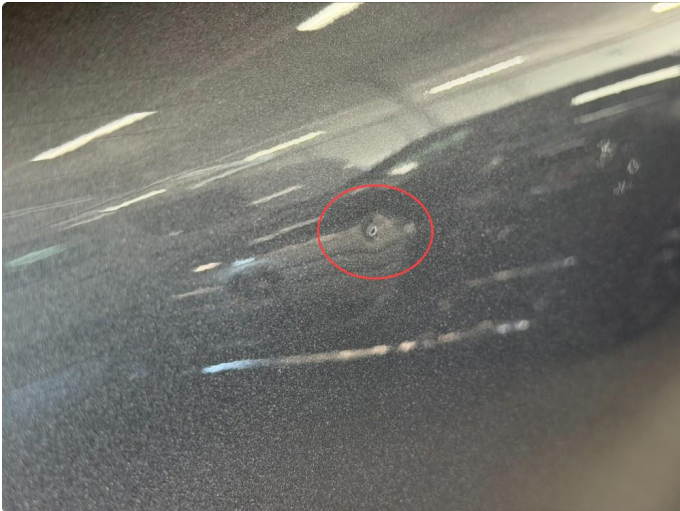
1.1 BBulk med lakkskade.
