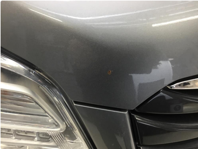
1.1 Noe steinsprut med rust
