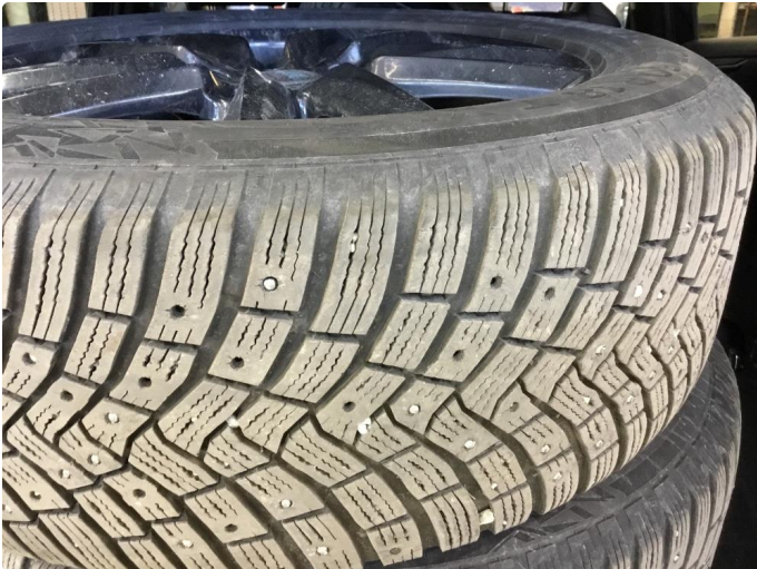
1.1 Piggdekk mangler pigger
