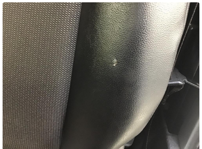
2.1 Skade på setetrekk
