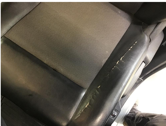
2.1 Skade på setetrekk
