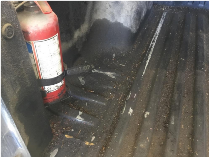
1.3 Slitt gjennom lakk
