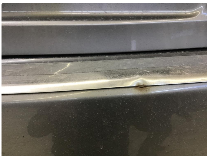
1.3 Ripe(r) ned til grunning
