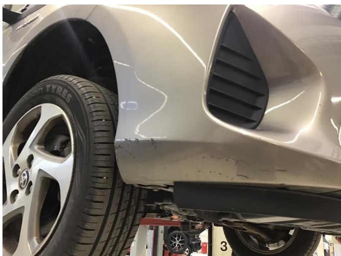
1.3 Ripe(r) ned til grunning
