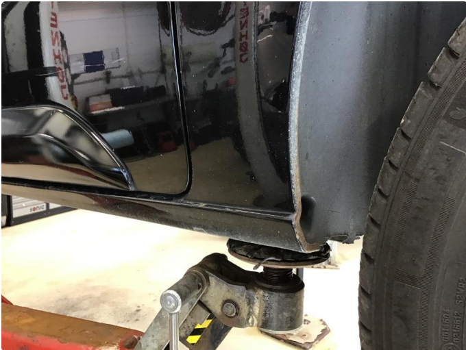
1.1 Steinsprut med rust
