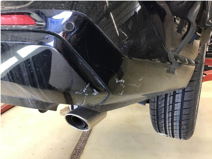
1.1 Ripe(r) ned til grunning
