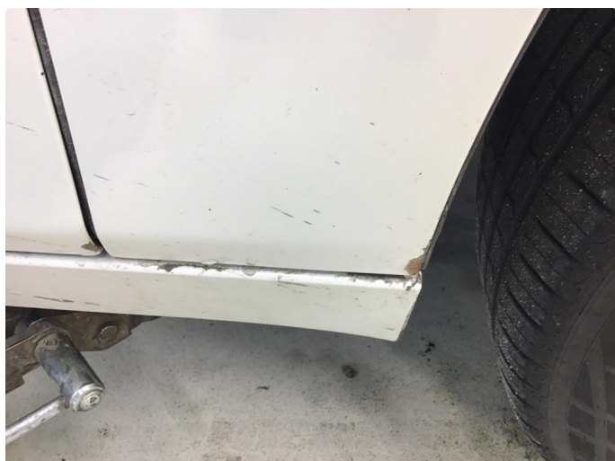
1.2 Steinsprut med rust
