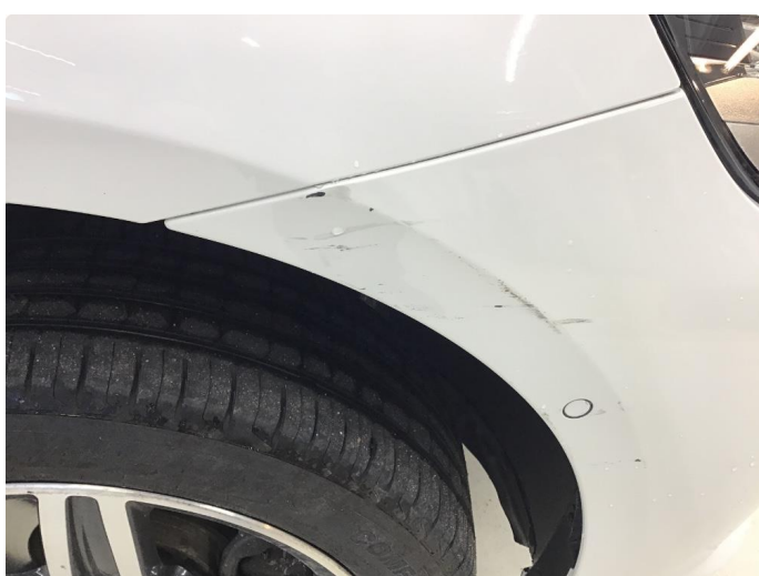
1.3 Ripe(r) ned til grunning
