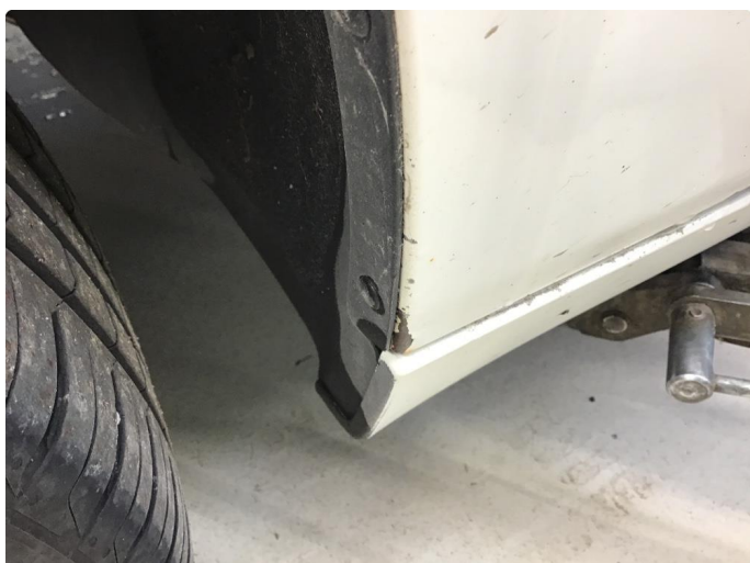
1.2 Steinsprut med rust
