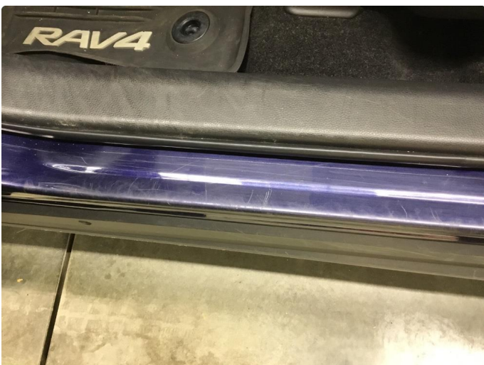
1.3 Bulk(er) med lakkskade
