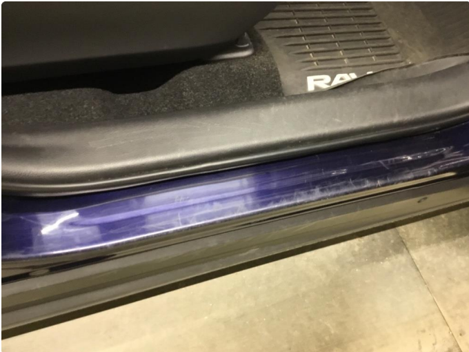
1.3 Bulk(er) med lakkskade
