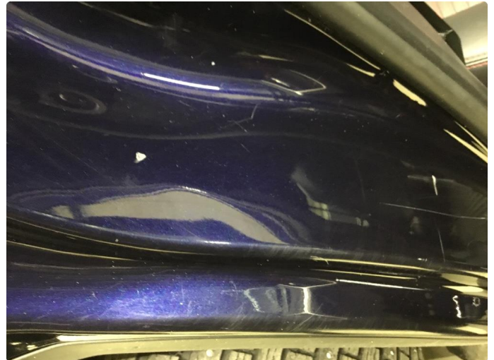
1.3 Bulk(er) med lakkskade
