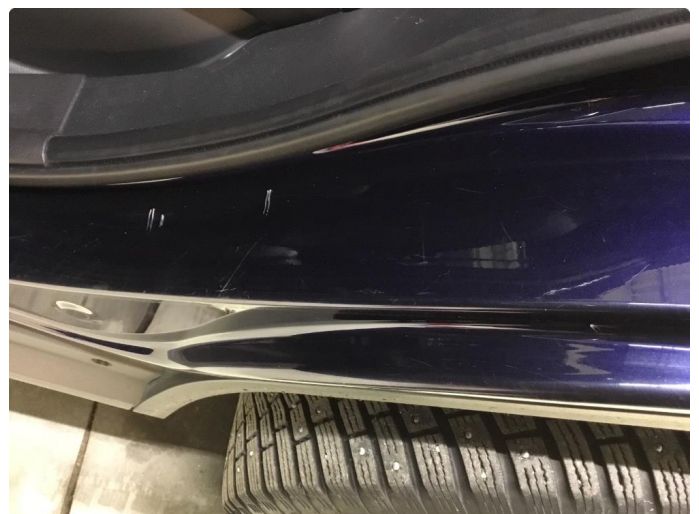
1.3 Bulk(er) med lakkskade
