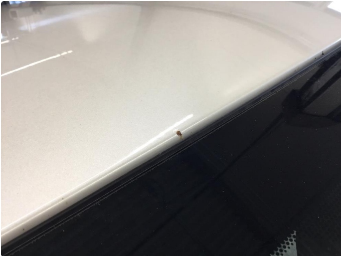
1.1 Steinsprut med rust
