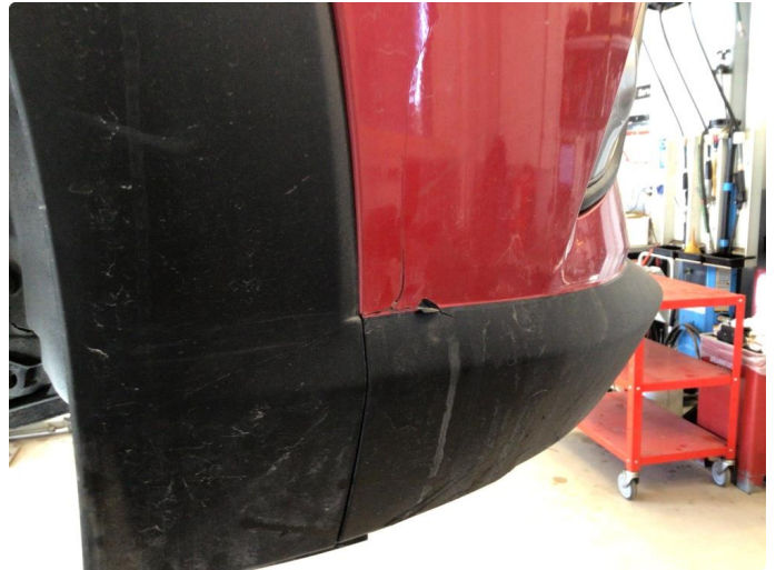
1.2 Liten sprekk i frontfanger høyre side
