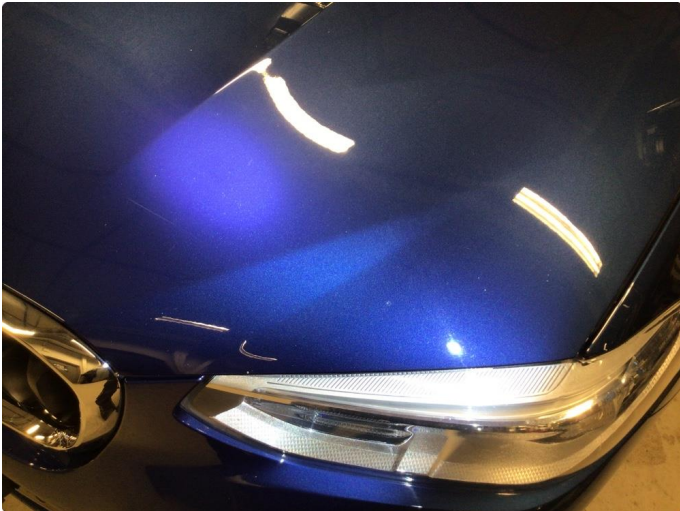
1.1 Steinsprut i panser
