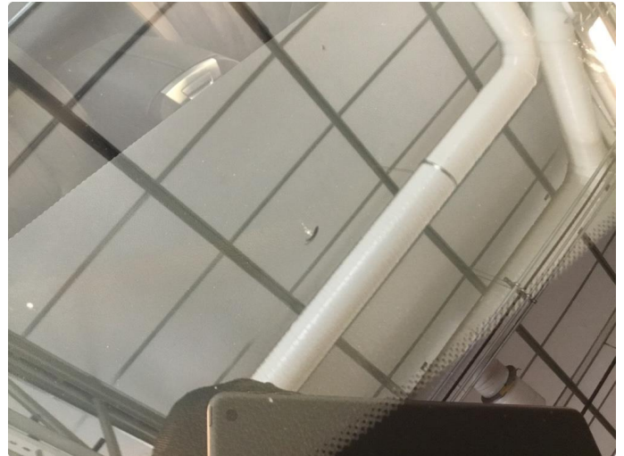
1.2 Liten reparert steinsprut i frontrute
