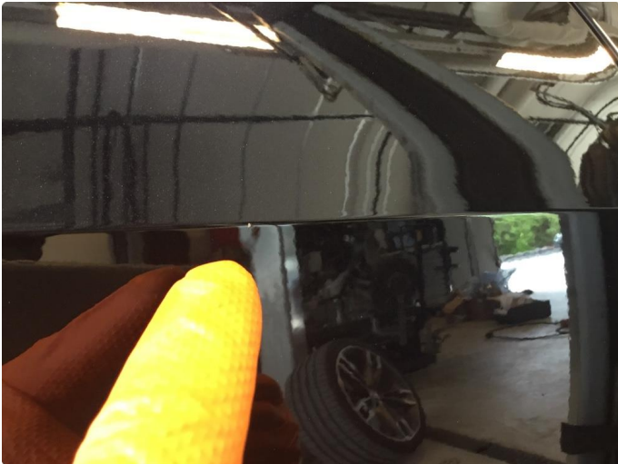
1.1 Veldig liten lakkskade i dør
