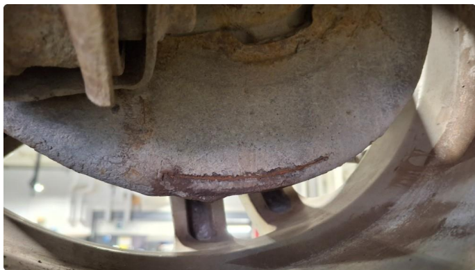
4.2 Skadet. Ligger inntil bremseskive.
