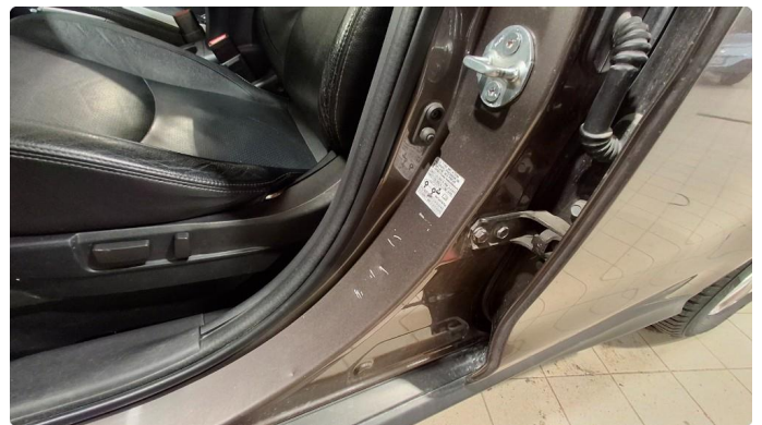
1.9 Noen riper og småbulker
