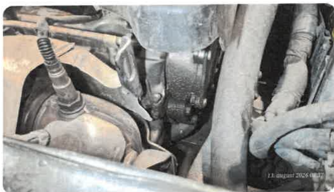
2.1 Oljelekkasje fra motor Er en liten lekkasje ved vakumpumpe i bakkant av topplock
