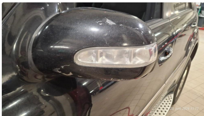
3.3 Krakelering i plast
