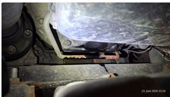
4.2 Lekkasje fra oljekjøler
