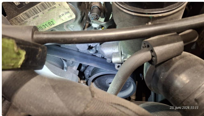
4.2 Lekkasje fra oljekjøler
