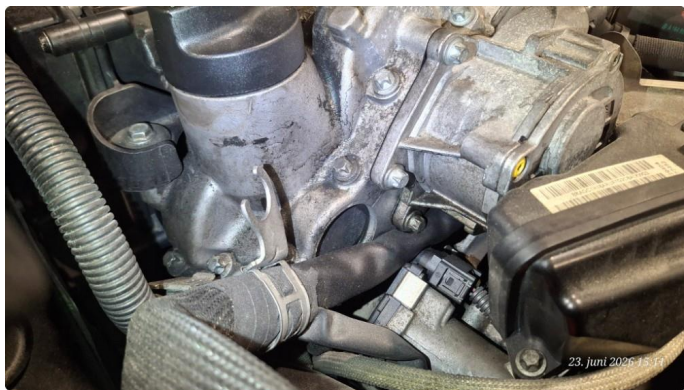
4.2 Lekkasje fra oljekjøler
