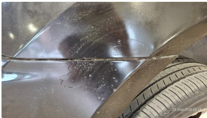
2.5 Ufagmessig utført arbeid
