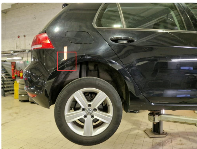
1.5 Rust høyre bakskjerm.
