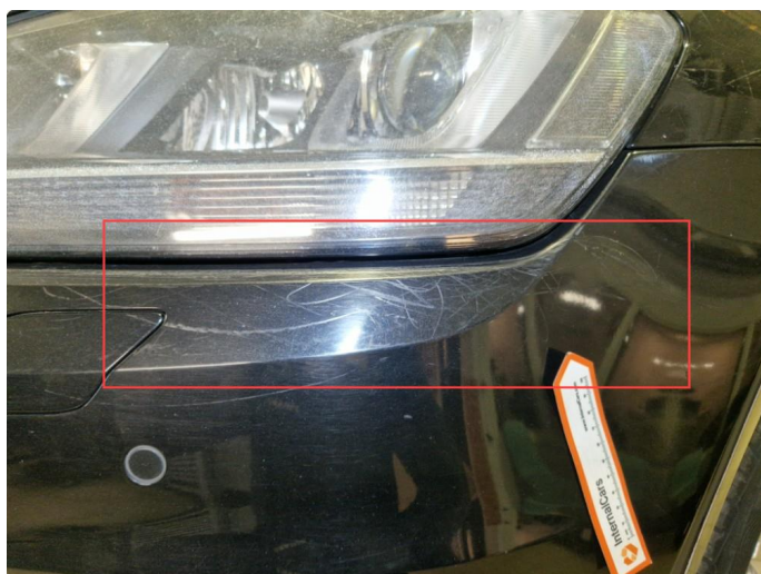
1.8 Lakkskader / bruksmerker frontfanger.
