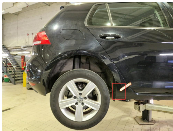
1.5 Rust høyre bakskjerm.
