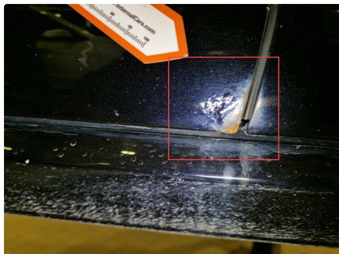
1.3 Rust fremre nedre del høyre bakdør.
