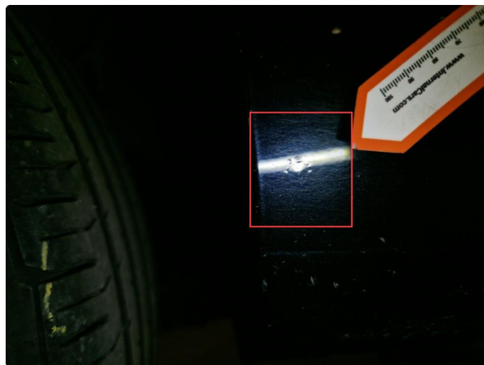
1.5 Rust høyre bakskjerm.
