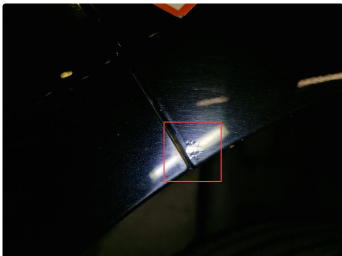
1.5 Rust høyre bakskjerm.
