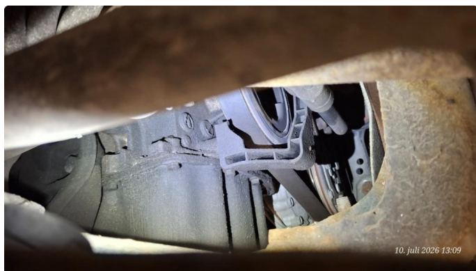
2.2 Svetter. Oljetetning i framkant motor.
