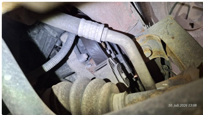
2.2 Svetter. Oljetetning i framkant motor.
