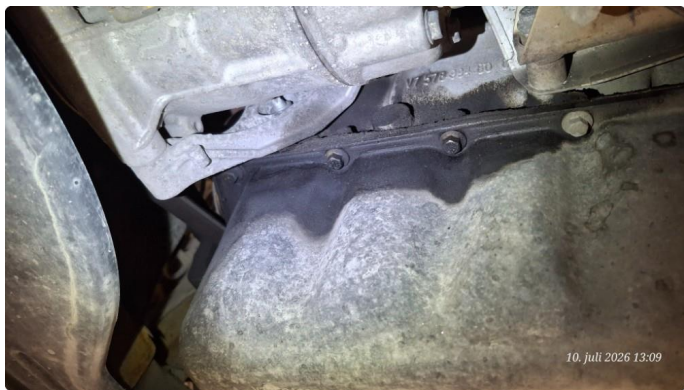
2.2 Svetter. Oljetetning i framkant motor.
