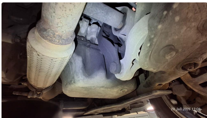
2.2 Svetter. Oljetetning i framkant motor.
