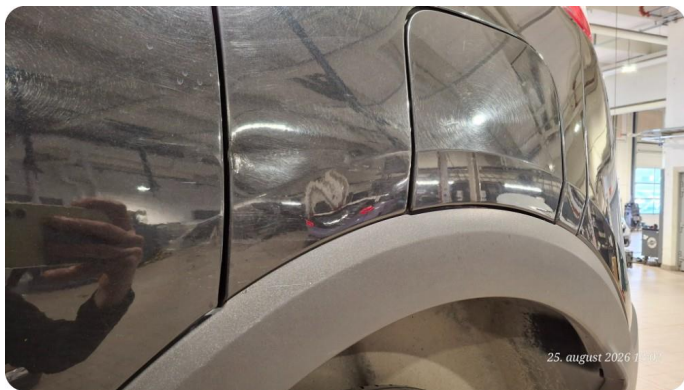
1.2 Bulk med lakkskade
