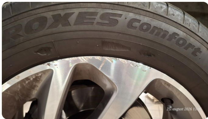
1.3 Dekkskade sommerhjul Skade på dekk venstre fram, begge bak er mørkne og har lite mønster
