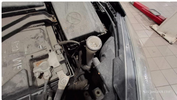
1.4 Mangler lokk til spylertank
