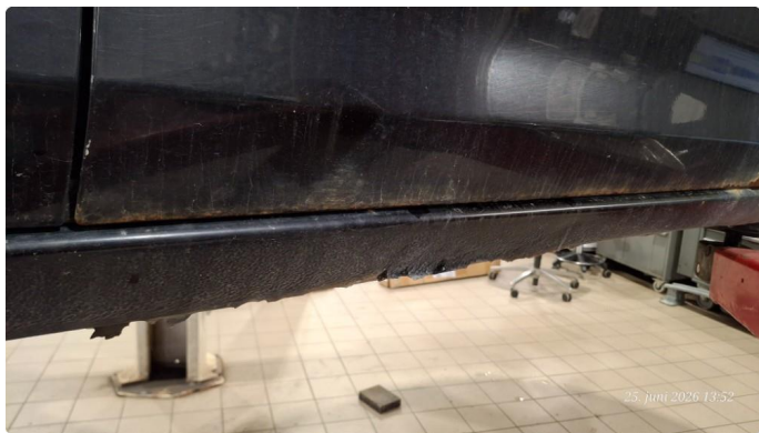
1.2 Generelt mye rust
