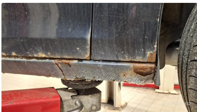
1.2 Generelt mye rust
