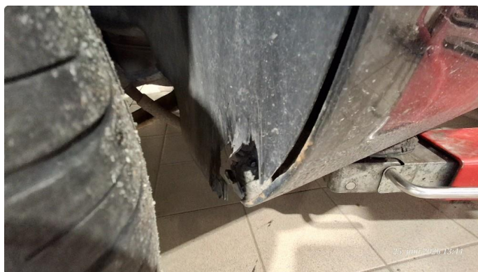
1.2 Generelt mye rust
