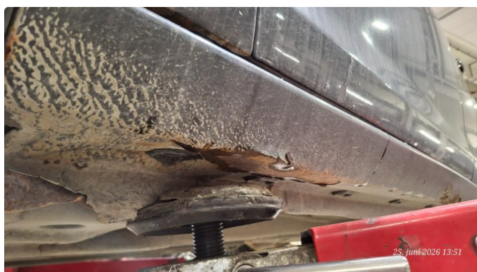
1.2 Generelt mye rust
