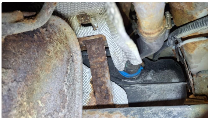
5.2 Dårlig feste drivstofftank
