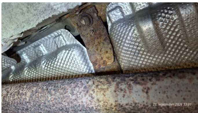
3.3 Generelt mye rust
