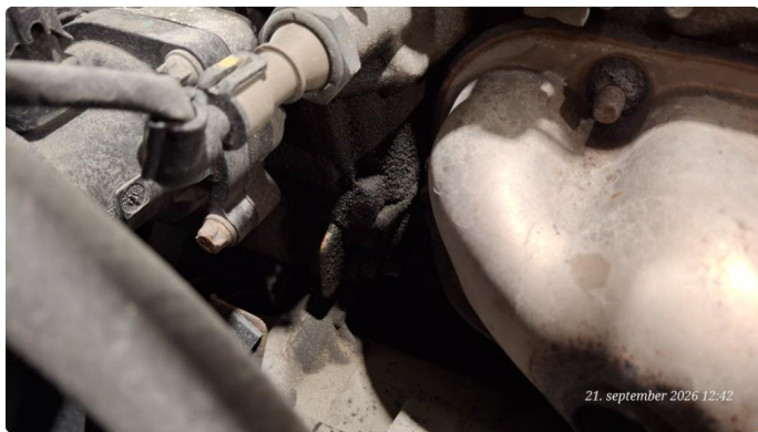
5.6 Oljelekkasje i forkant
