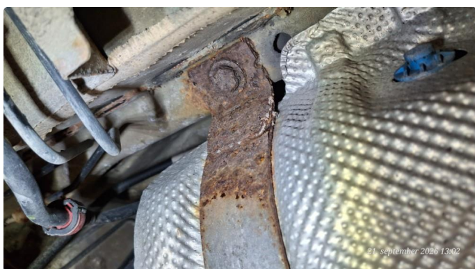
5.2 Dårlig feste drivstofftank
