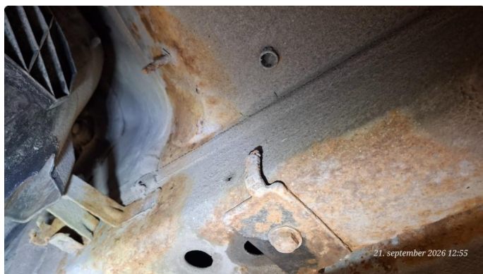
3.3 Generelt mye rust
