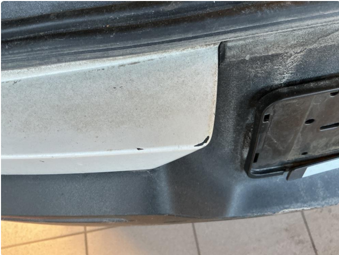
1.1 Ripe(r) ned til grunning
