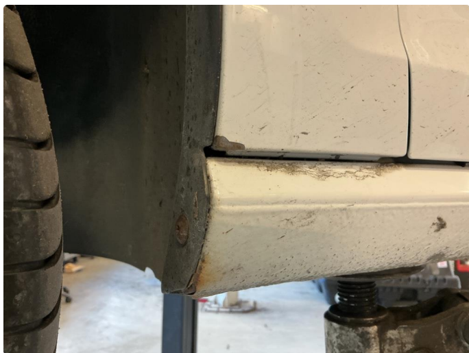
1.5 Noe overflaterust, vi har lagt på lakk
