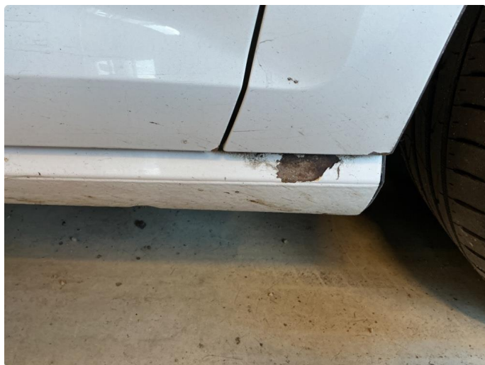
1.15 Overflate rust, vi kan flekk-lakke over
