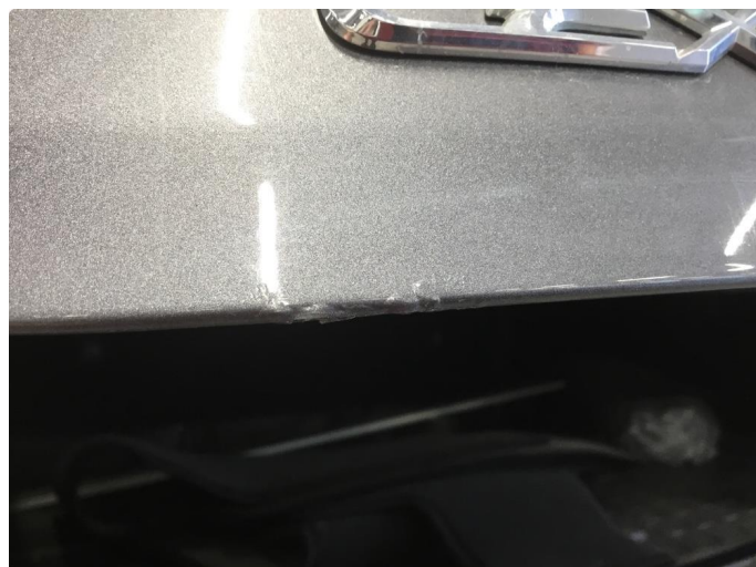
1.2 Steinsprut med rust
