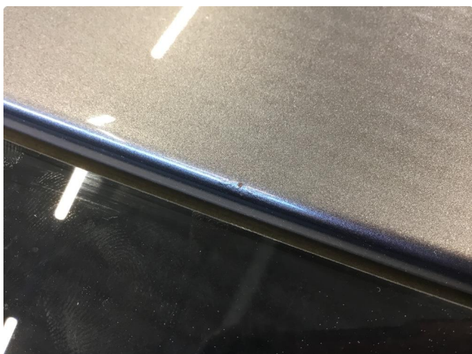
1.4 Steinsprut med rust
