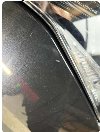
2.8 Ripe(r) -Noe riper/steinsprut på frontfanger.
