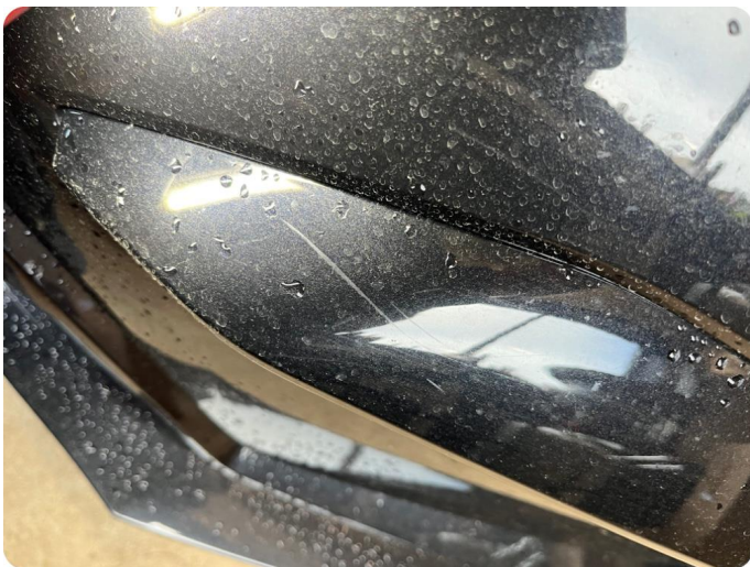
2.8 Ripe(r) -Noe riper/steinsprut på frontfanger.
