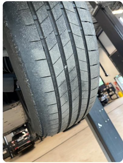
2.5 Skjev slitasje på sommerdekk -Kantslitte sommerdekk.
