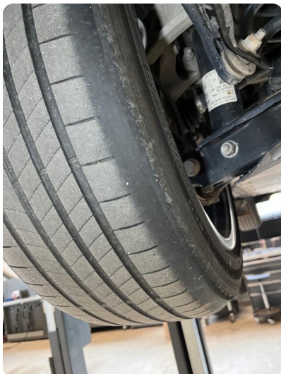
2.5 Skjev slitasje på sommerdekk -Kantslitte sommerdekk.
