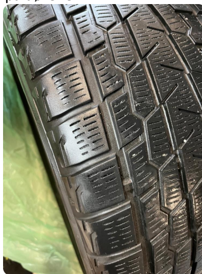
2.4 Skjev slitasje på vinterdekk -Kantslitte vinterdekk(værst bak).
