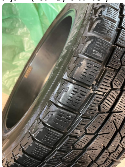
2.4 Skjev slitasje på vinterdekk -Kantslitte vinterdekk(værst bak).
