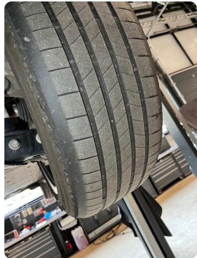
2.5 Skjev slitasje på sommerdekk -Kantslitte sommerdekk.
