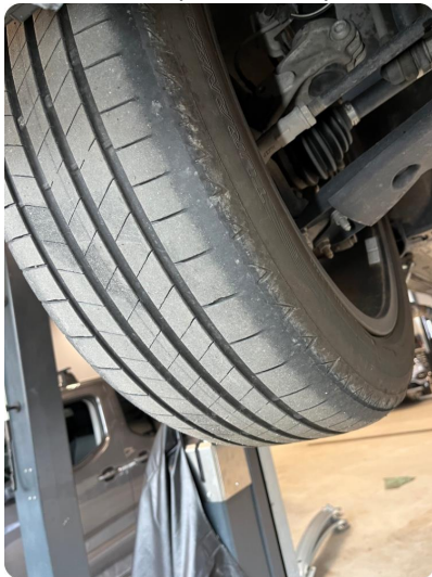
2.5 Skjev slitasje på sommerdekk -Kantslitte sommerdekk.
