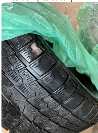
2.4 Skjev slitasje på vinterdekk -Kantslitte vinterdekk(værst bak).
