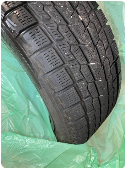
2.4 Skjev slitasje på vinterdekk -Kantslitte vinterdekk(værst bak).
