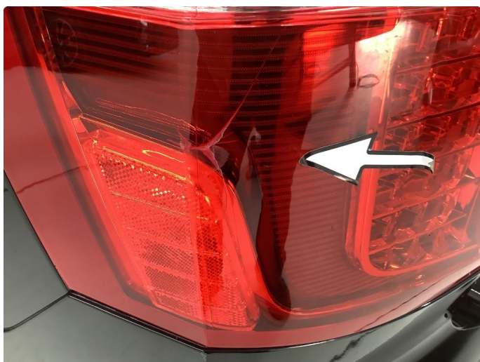
2.1 Defekt / sprukket glass
