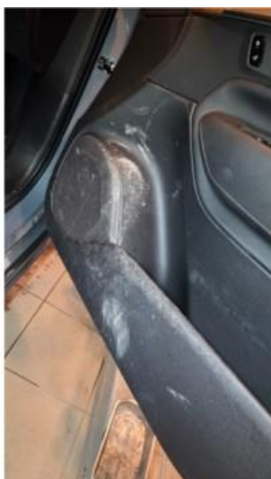
2.1 Merker på dørtrekk, høyre fordør
