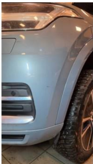
1.1 Små lakkskader på begge sider av støtfanger foran
