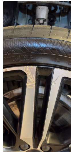
1.1 Kantkjørt merke på to av vinterfelgene
