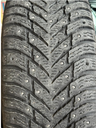
1.1 2 stk vinterdekk mangler noen pigger
