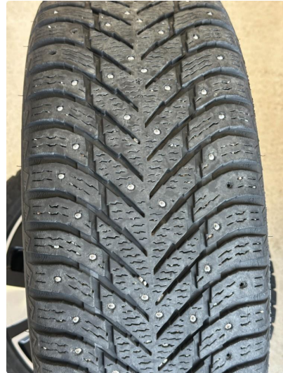
1.1 2 stk vinterdekk mangler noen pigger
