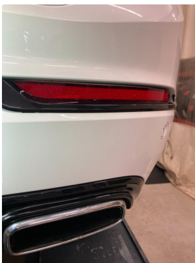
1.3 Liten skade v. refleks høyre bak
