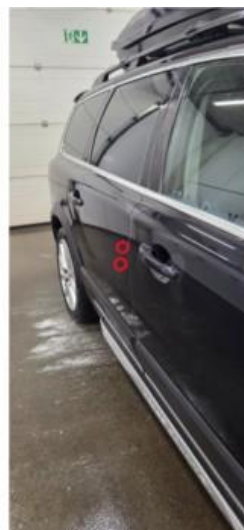
1.3 To små bulker på høyre bakdør
