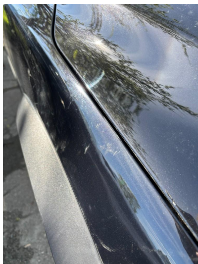
1.4 Lakkskade på høyre forskjerm
