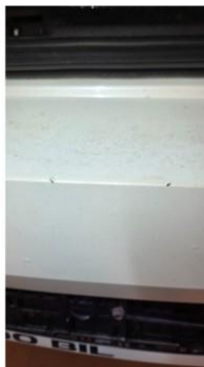
1.3 To hakk i innlastningssone på støtfanger bak, flekkes
