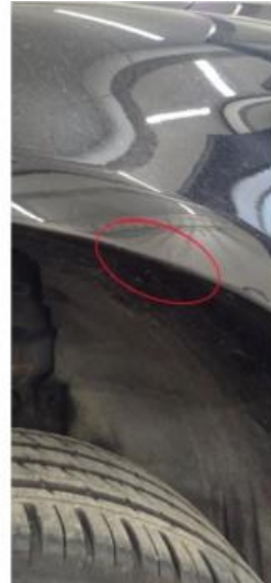
1.1 Korrosjon ved hjulbuer foran
