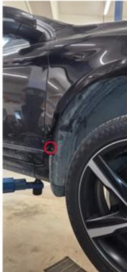
1.1 Korrosjon ved hjulbuer foran
