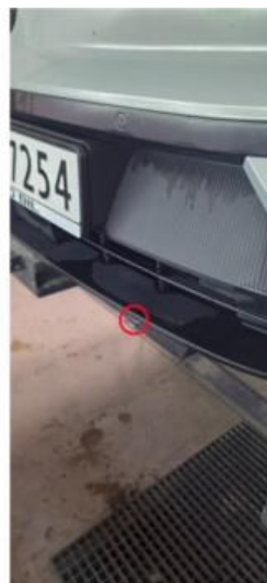
1.2 Lite hakk i støtfanger foran
