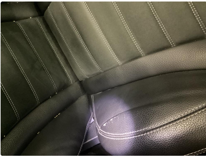
2.1 Skade på setetrekk
